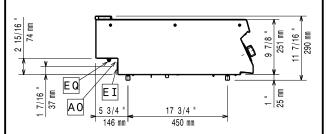
**EI** = Electrical inlet (power) **EQ** = Equipotential screw
